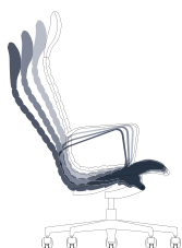
inclinaison du dossier sur 4 positions Backrest inclination adjustment in 4 positions Kantelbare rug in 4 posities
