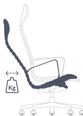
Tension de basculement Tilt tension adjustment Regelbare weerstand
